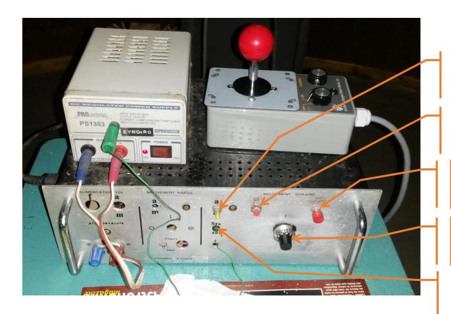
A - Mise sous tension de la puissance pour suivi (fabrication d'un signal 230 V carré avec fréquence variable)
