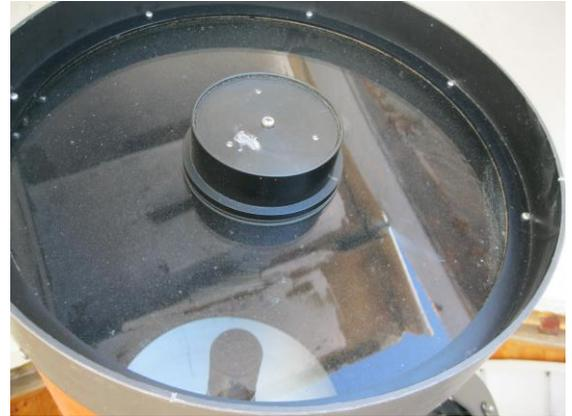
**Etape 1 :** Tout en veillant à ne pas toucher la lame de fermeture, placer deux repères différents (encoches ou colorés) diamétralement opposés avec deux papiers collant sur l'intérieur du tube et sur l'arceau maintenant la lame de fermeture.
