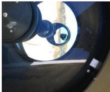
**Etape 2 :** Positionner le télescope à la vertical, desserrer les 8 vis de l'arceau délicatement. Retirer l'arceau avec les deux mains sans enlever le liège de l'arceau.
